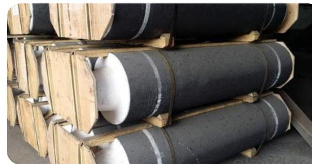
Si consumano  $0.8-1.2\text{kg}_{\text{elettrodo}}/\text{t}_{\text{acciaio}}$
